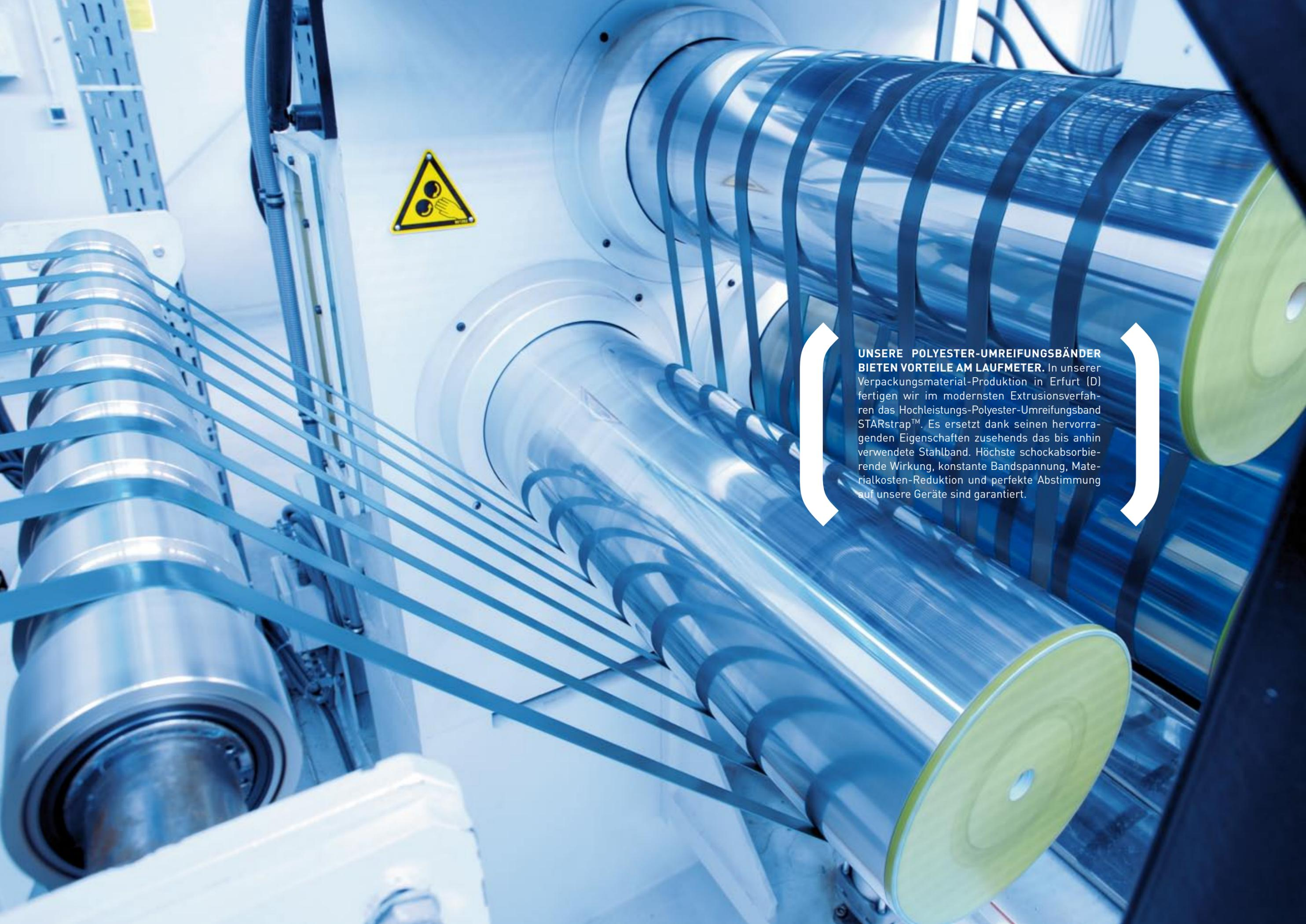
**UNSERE POLYESTER-UMREIFUNGSBÄNDER BIETEN VORTEILE AM LAUFMETER.** In unserer Verpackungsmaterial-Produktion in Erfurt (D) fertigen wir im modernsten Extrusionsverfahren das Hochleistungs-Polyester-Umreifungsband STARstrap™. Es ersetzt dank seinen hervorragenden Eigenschaften zusehends das bis anhin verwendete Stahlband. Höchste schockabsorbierende Wirkung, konstante Bandspannung, Materialkosten-Reduktion und perfekte Abstimmung auf unsere Geräte sind garantiert.
